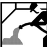
подайте (налив / подача насосом) перемешанный состав на свеженанесённую грунтовку (по-мокрому) и равномерно распределите состав по поверхности
